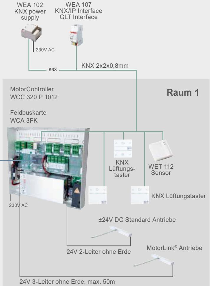
**Beispiel 5: WCC 320 P 1012 mit BACnet MS/TP / Modbus RTU/RS485 Karte erweitert oder BACnet-IP Schlüssel**
