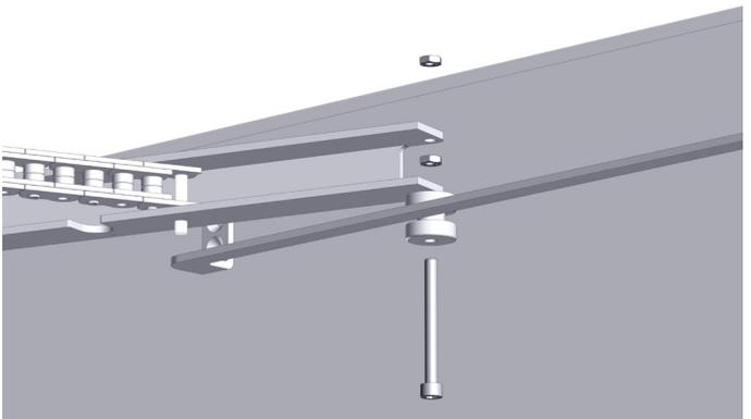
Befestigen Sie mit der beiliegenden Schraube das Rad unter dem Motorarm. Achten Sie darauf, dass das Rad hinter der Konsole **WDB 820M** befestigt ist. Ziehen Sie die Schrauben mit einem Drehmoment von 2 Nm an.
