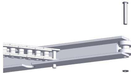
Entfernen Sie den Federring.
